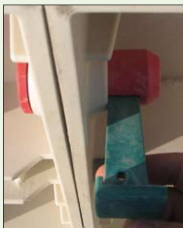
Vsadte klín do čepu tak jak je ukázáno rovnou stranou klínu směrem ke spoji.
